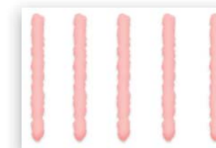
Do klejenia płyt izolacyjnych przy termoizolacji fundamentów – wydajność 14 m 2
